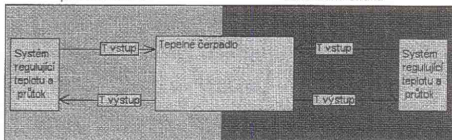
Obrázek č.2. - Schéma zkušebního systému: primární strana sekundární strana
